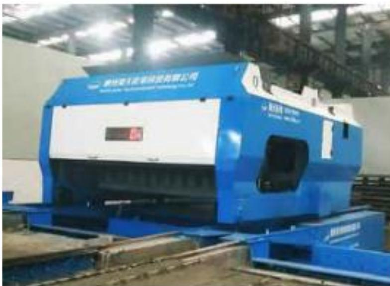
Линия безопалубочного формования пустотных плит методом послойного уплотнения на слипформере.
