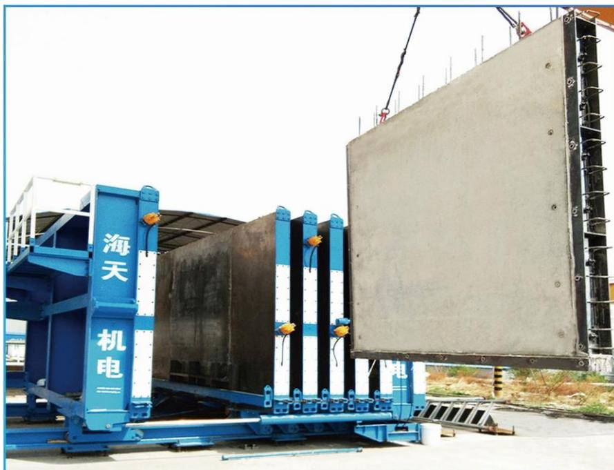
Кассетная установка для массового выпуска внутренних панелей производит панели с толщиной от 80 до 350 мм, с высоким качеством поверхности на обеих сторонах.
